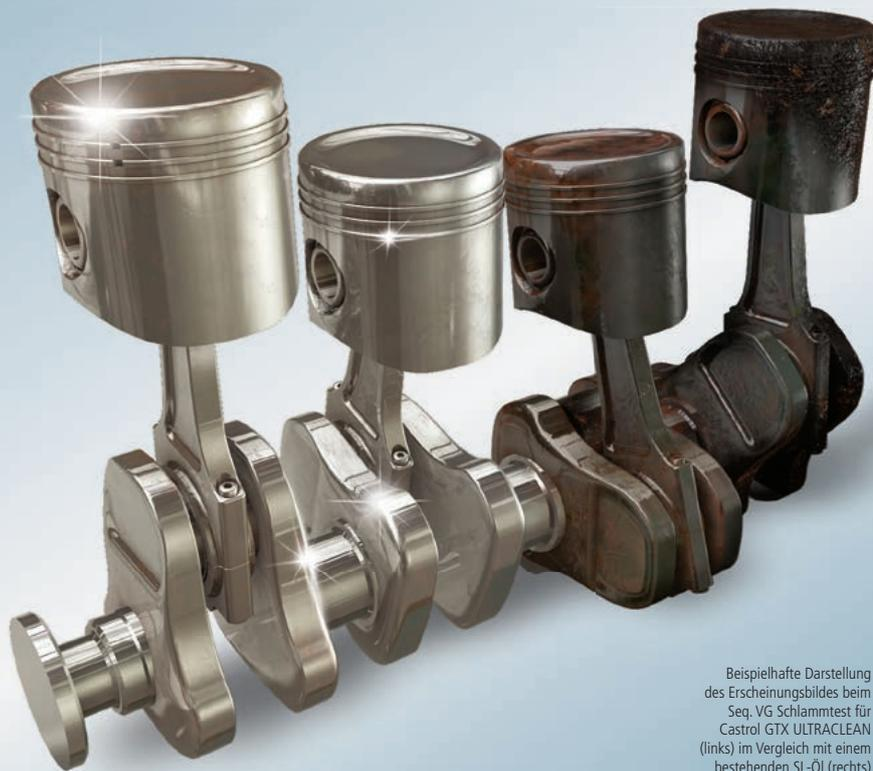
Beispielhafte Darstellung des Erscheinungsbildes beim Seq. VG Schlammtest für Castrol GTX ULTRACLEAN (links) im Vergleich mit einem bestehenden SL-Öl (rechts)
